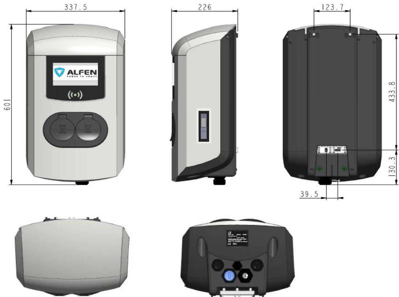
Abbildung 15 - Abmessungen der Eve Pro Ladestation
