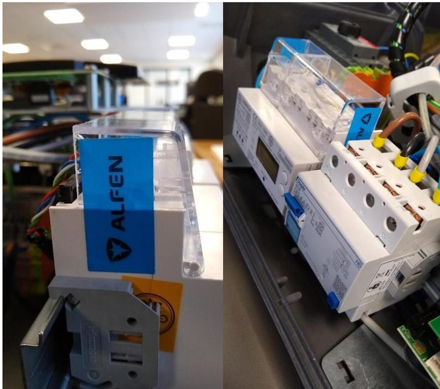
Abbildung 12 - Adapter mit Alfen-Herstellersiegel
